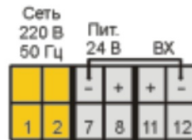
Схема электрических присоединений PMS-620T/E
