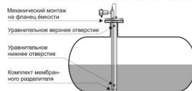
Рисунок 3 – Пример установки прибора на резервуаре
