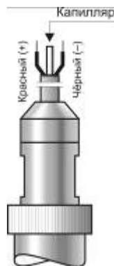
Тип PK Степень защиты IP 68 Кабельное электрическое соединение, соединение с атмосферой через капилляр, находящийся в кабеле, длина кабеля 3 м (стандартное исполнение)
