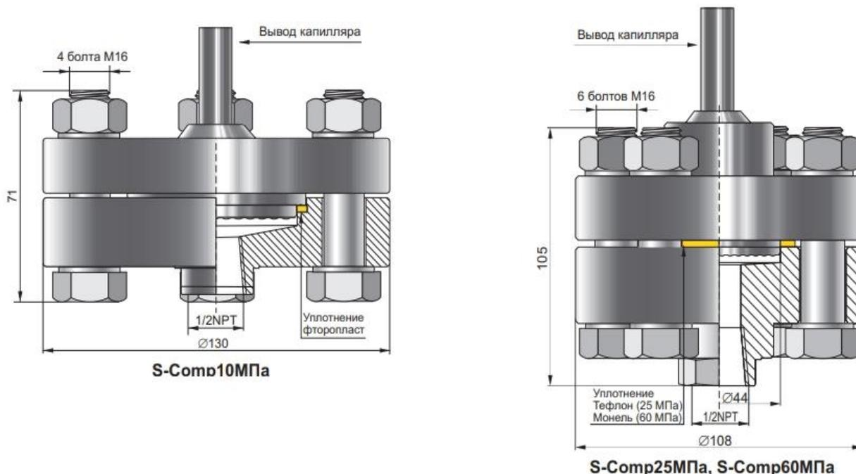
Разделитель предназначен для измерения давления газов, паров и жидкостей с температурой до 180°C. Применяется в различных отраслях промышленности, а также в энергетике для съема статического давления паровой фазы в барабанах котлов в случае измерения уровня воды с помощью
