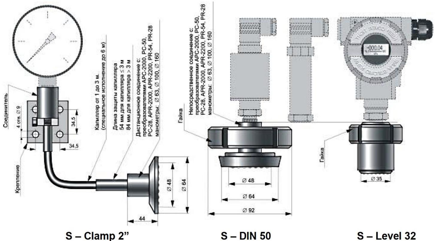
Разделители S – DIN , S – Clamp, S - Level, оснащенные стандартными гигиеническими соединителями, обеспечивают возможность измерения давления в гигиенических условиях в пищевой и фармацевтической промышленности. Разделитель S – Level рекомендуется монтировать в дно емкости, не создавая углубления, в котором могут собираться осадки и остатки среды измерения или моющего раствора.
