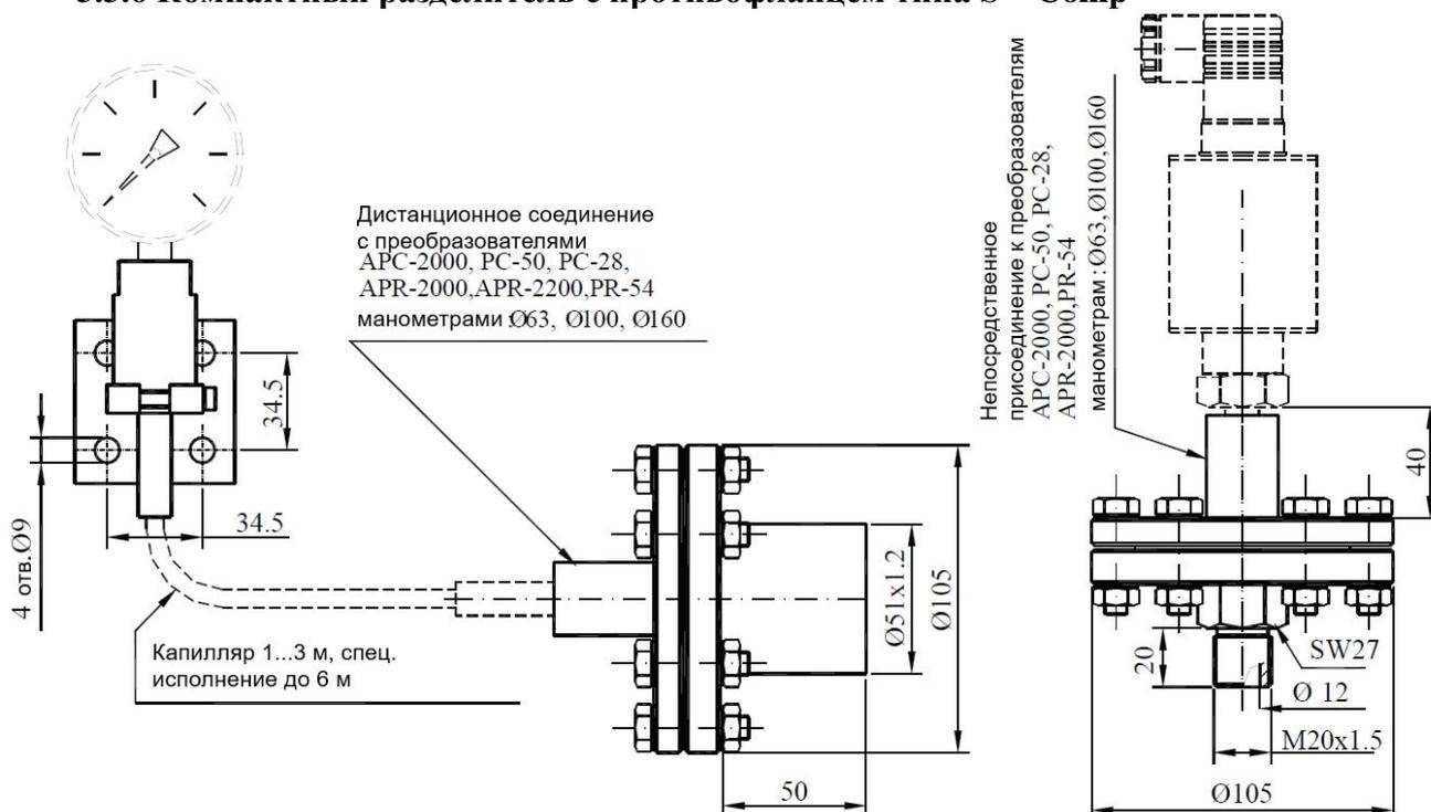
Разделители типа S – Comp оснащены разделительной мембраной диаметром 70 мм, сохраняя при этом экономичную, компактную конструкцию устройства.
