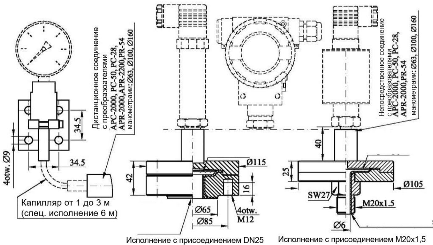
Разделители типа S – Comp Ch предназначены для измерения давления химически агрессивных сред. Части разделителя непосредственно контактирующие с измеряемой средой изготовлены из тефлона и тантала. Эти материалы позволяют проводить измерения давления агрессивных химических соединений – таких как соляная, серная, азотная кислоты в любых концентрациях измерение давления хлора за исключением фтороводородной кислоты, газового фтора и щёлочи натрия.
