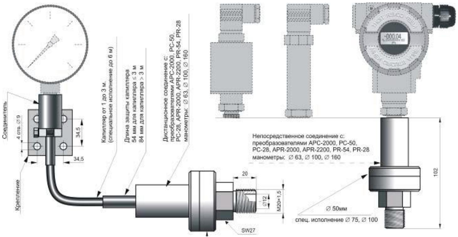
Разделитель S-Mazut используется для измерения сред с повышенной вязкостью и температурой до 150 °C (315 °C для дистанционного разделения). Типичным применением является измерение давления мазута в горелках и узлах мазута энергетических котлов.
