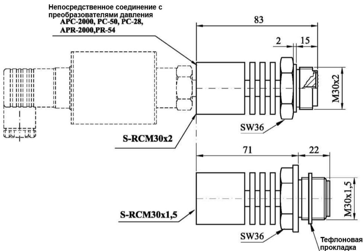
характеризующихся повышенной вязкостью, застыванием, загрязнением, там, где невозможно использовать импульсную трубку. Для монтажа преобразователей с разделителями S-RC на месте предлагаются монтажные кольца для сварного соединения от Aplisens.
