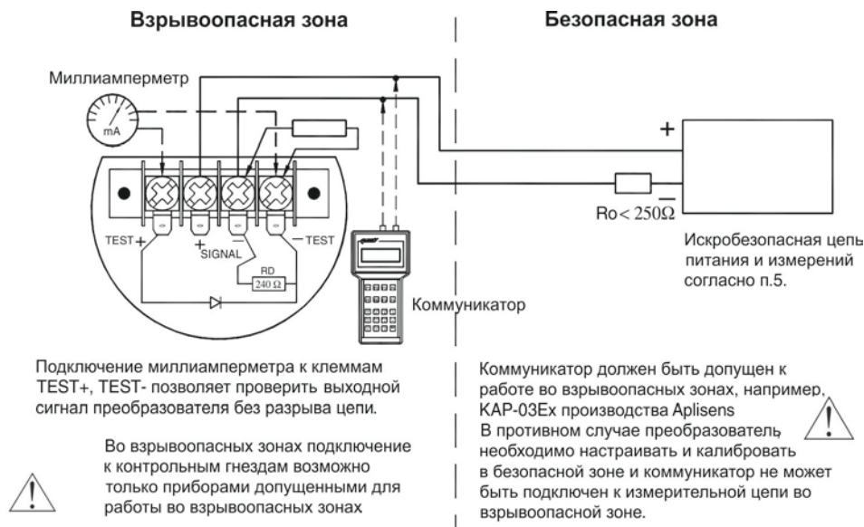
Рисунок 6.1. Схема подключения преобразователя
