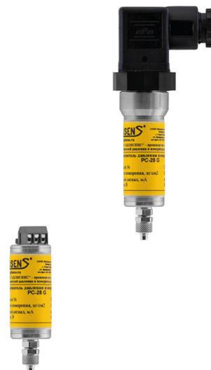
Преобразователь давления измерительный **PC-28G** предназначен для измерения избыточного, вакуумметрического давления газов. Преобразует унифицированный пневматический сигнала **20...100 кПа** в унифицированный электрический сигнал **4...20 мА (двухпроводная линия)**.
