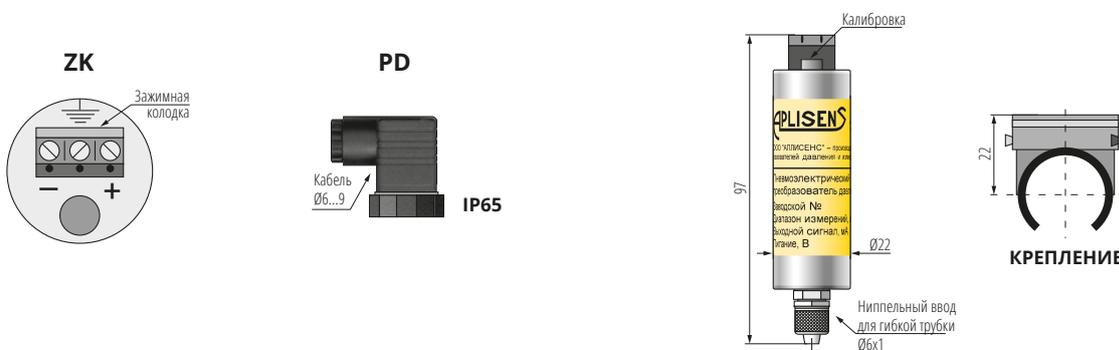
Первичным измерительным элементом является пьезорезистивный кремниевый модуль. Для подключения входного сигнала преобразователь снабжен ниппельным вводом для гибкой трубки **Ø6×1**. Электрическим присоединением является зажимная колодка **типа ZK** либо штепсельный разъем типа **DIN 43650**, степень защиты **IP65**.
