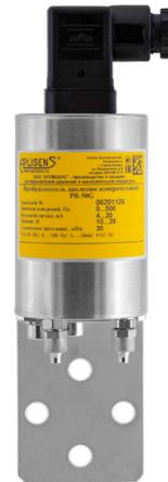
Датчик **PR-50G** предназначен для измерения давления, вакуумметрического давления, а также разницы давления безвредных газов. Типичным применением датчика является измерение давлений порывов, тяги дымоотводов или давления (также вакуумметрического давления) в камерах сгорания.
