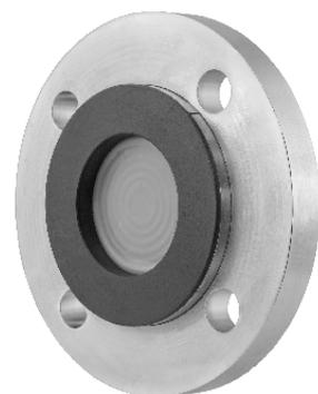
Разделитель типа **S-Ch** является мембранным передатчиком давления. Сигнал давления передается на взаимодействующий манометр или датчик с помощью манометрической жидкости, заполняющей пространство между мембраной и манометром.
